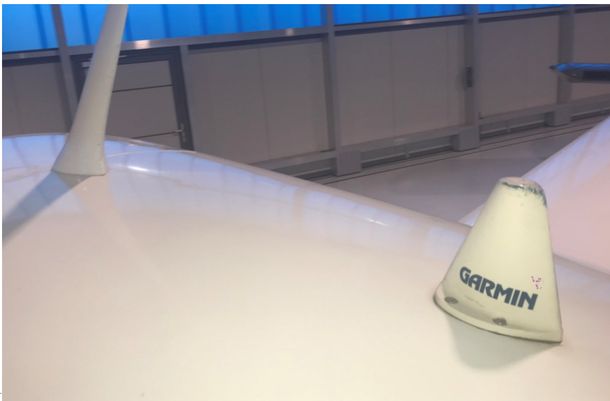
Stumpfer, dünner Lack auf Dem Dach
