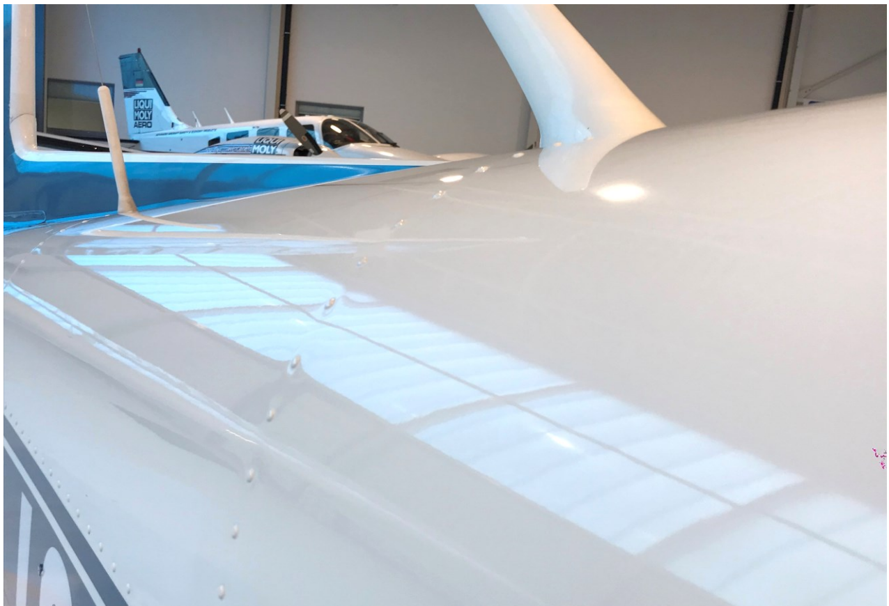
Nach 3 Politurdurchgängen und Aufbringung von HighGloss Versiegelung UV Schutz Extra
